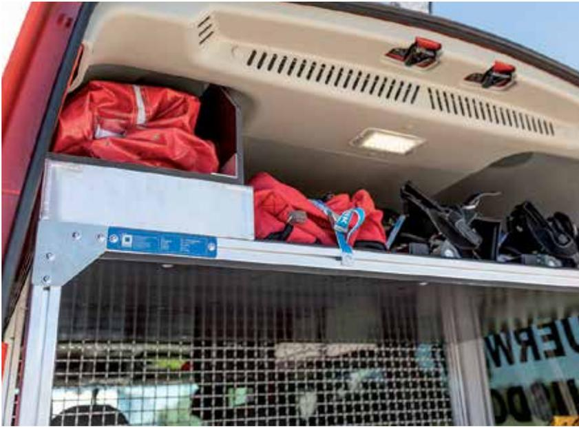
Im Einsatz alles griffbereit: Wenn Sekunden entscheidend sein können, hilft perfekt verstaute Ausrüstung. Mit Haltern, Zwischenböden, Ablagemöglichkeiten und sauberen Verkleidungen ausgestattet, ist das Einsatzfahrzeug eine professionelle Systemlösung.
