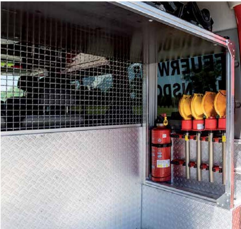
Das im Profilkanal montierte Trenngitter sorgt für zusätzliche Sicherheit bei trotzdem guter Rundumsicht.
